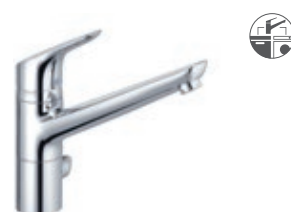
Spültisch-Multi-Einhandmischer DN 15 schwenkbarer Auslauf (360°) Anschluss für Wasch-/Spülmaschine H1 210, H2 169, A 203, Ø2 52 325760575 ■
