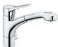
Spültisch-Multi-Einhandmischer DN 15 schwenkbarer Auslauf (110°) herausziehbare Geschirrbrause mit Umstellung Brause/Strahl Anschluss für Wasch-/Spülmaschine H1 220, H2 153, A 225, Ø1 34, Ø2 58 399450562 ■ 399458262 ■ 399459262 □
