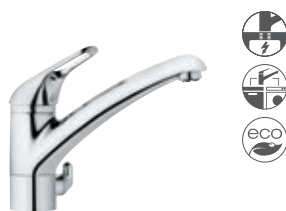
Spültisch-Multi-Einhandmischer DN 10 schwenkbarer Auslauf (360°) Anschluss für Wasch-/Spülmaschine für drucklose Speicher H1 180, H2 150, A 200, Ø2 52 337970562 ■
