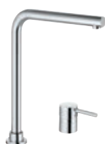
Spültisch-Einhandmischer DN 10 schwenkbarer Auslauf (360°) Zweilochmontage H1 321, H2 280, A 210, Ø1 34, Ø2 48 428540577 ■
