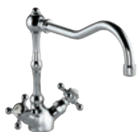
Spültischarmatur DN 8 schwenkbarer Auslauf (360°) H1 245, H2 180, A 250, Ø1 28, Ø2 52 516060520 ■
