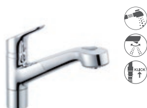
Spültisch-Einhandmischer DN 15 herausziehbare Geschirrbrause mit Umstellung Brause/Strahl schwenkbarer Auslauf (110°) H1 204, H2 129, A 208, Ø1 34, Ø2 52 325810575 ■
