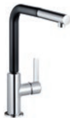
Spültisch-Einhandmischer DN 15 schwenkbarer (360°), herausziehbarer Auslauf H1 295, H2 265, A 220, Ø2 38 408518775 ■
