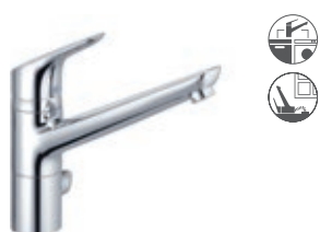
Spültisch-Multi-Bajonett-Einhandmischer DN 15 für Unterfenstermontage schwenkbarer Auslauf (360°) Anschluss für Wasch-/Spülmaschine H1 213, H2 172, A 203, Ø1 34, Ø2 52 325790575 ■
