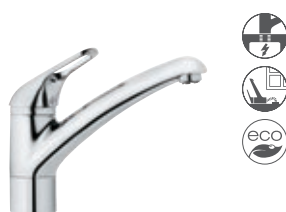
Spültisch-Bajonett-Einhandmischer DN 10 für Unterfenstermontage schwenkbarer Auslauf (360°) für drucklose Speicher H1 185, H2 150, A 200, Ø1 35, Ø2 52 337930562 ■
