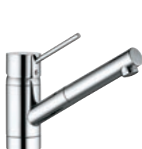
Spültisch-Einhandmischer DN 8 schwenkbarer (110°), herausziehbarer Auslauf für drucklose Speicher H1 177, H2 122, A 197, Ø1 35, Ø2 52 339320575 ■
