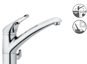
Spültisch-Multi-Bajonett-Einhandmischer DN 10 für Unterfenstermontage schwenkbarer Auslauf (360°) Anschluss für Wasch-/Spülmaschine H1 185, H2 150, A 200, Ø1 35, Ø2 52 337990562 ■
