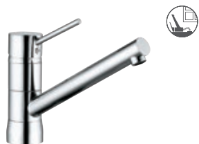
Spültisch-Bajonett-Einhandmischer DN 10 für Unterfenstermontage schwenkbarer Auslauf (360°) H1 172, H2 125, A 200, Ø1 35, Ø2 48 339380575 ■ 339389675 ■
