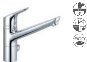
Spültisch-Multi-Einhandmischer DN 15 schwenkbarer Auslauf (360°) Anschluss für Wasch-/Spülmaschine für drucklose Speicher H1 209, H2 167, A 204, Ø2 52 325770575 ■
