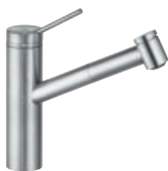
Spültisch-Einhandmischer DN 10 herausziehbare Geschirrbrause mit Umstellung Brause/Strahl (110°) H1 236, H2 172, A 213, Ø1 34, Ø2 52 44941F875 ■
