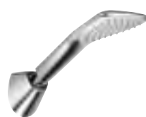
6757005-00 Kopfbrause DN 15 Wandmontage mit justierbarem Kugelgelenk (max. Neigungswinkel 36°)
