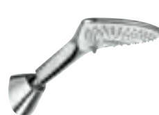
6758005-00 Kopfbrause DN 15 umstellbar auf drei Strahlarten: Booster, Smooth, Volumen mit justierbarem Kugelgelenk (max. Neigungswinkel 36°)
