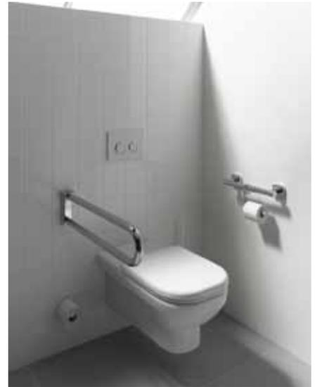
Der Stützklappgriff kann mit wenigen Handgriffen ergänzt werden. Wird der Stützklappgriff in einem anderen Zimmer benötigt, verschwindet die in der Wand verankerte Montagevorrichtung hinter einer verchromten Abdeckplatte.
