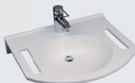
Privo Waschtisch aus Varicor®, ohne Überlauf, unterfahrbar, DIN 18040, 600 x 550 mm, Modell-Nr. 402160 mit Ausschnitten.
