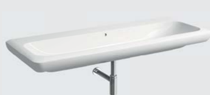
Waschtisch ohne Hahnloch, 1300 x 480 mm, Modell-Nr. 121933. Kombinierbar mit Halbsäule oder Waschtischunterschränken 1200 mm.
