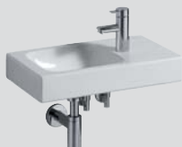
Waschtisch, ohne Überlauf, 530 x 310 mm. Modell-Nr. 124153 Ablagefläche links. Modell-Nr. 124053 Ablagefläche rechts. Mit Schaffventil mit Ablaufkappe erhältlich. Kombinierbar mit Waschtischunterschranken 520 mm.
