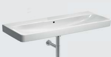
Waschtisch ohne Hahnlöcher, mit Überlauf, 1200 x 480 mm, Modell-Nr. 120523. Kombinierbar mit Waschtischunterschränken 1168 mm.
