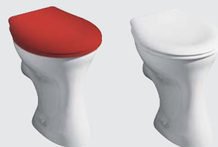
Kind Flachspül-WC, 6 l, bodenstehend, Abgang waagrecht, 330 x 350 x 430 mm, Modell-Nr. 211500. Kombinierbar mit Kind WC-Sitz, Modell-Nr. 573337 Rot. Modell-Nr. 573334 Weiß. Auch kombinierbar mit Kind WC-Sitzen im Tierdesign und Kind WC-Sitzring im Tierdesign.
