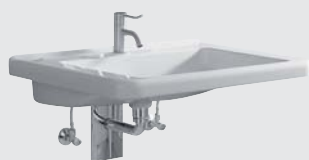
Waschtisch, mit Hahnloch, ohne Überlauf, unterfahrbar, DIN 18040, zwei Wasserebenen im Innenbecken, 650 x 550 mm, Modell-Nr. 128667. Kombinierbar mit Halbsäule, Modell-Nr. 298510 oder Waschtischunterschrank 530 mm.
