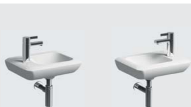
Handwaschbecken ohne Überlauf, 400 x 280 mm. Modell-Nr. 272940 Hahnloch links. Modell-Nr. 271940 Hahnloch rechts. Mit Schaffventil mit Ablaufkappe erhältlich. Kombinierbar mit Handwaschbecken-Unterschränken 304 mm.
