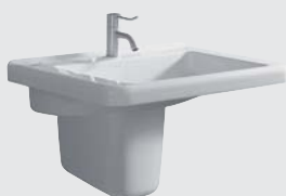
Waschtisch, mit Hahnloch, ohne Überlauf, unterfahrbar, zwei Wasserebenen im Innenbecken, 550 x 525 mm, Modell-Nr. 128557. Kombinierbar mit Halbsäule, Modell-Nr. 298510.
