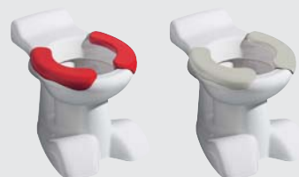
Kind Tiefspül-WC, 6 l, bodenstehend, Abgang waagrecht, 330 x 300 x 500 mm, mit 2-teiligen Sitzflächen, Modell-Nr. 212010 Rot. Modell-Nr. 212015 Grau.
