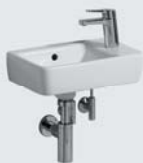
Handwaschbecken, asymmetrisch, Hahnloch rechts, 400 x 250 mm, Modell-Nr. 276140. Kombinierbar mit Handwaschbecken-Unterschränken 348 mm.
