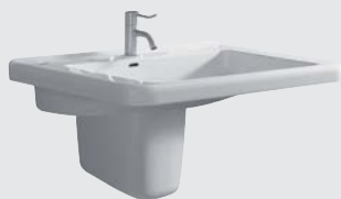
Waschtisch, mit Hahnloch, mit Überlauf, unterfahrbar, DIN 18040, zwei Wasserebenen im Innenbecken, 650 x 550 mm, Modell-Nr. 128665. Kombinierbar mit Halbsäule, Modell-Nr. 298510 oder Waschtischunterschrank 530 mm.
