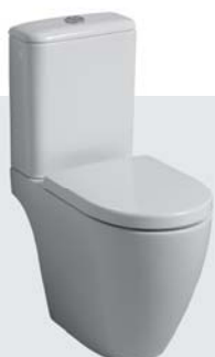
Tiefspül-WC-Kombination, spülrandlos, 6 l, bodenstehend, Abgang Multi, 375 x 830 x 640 mm, Modell-Nr. 200460. Keramik-Spülkasten mit Zweimengenspülung 3 l/6 l, Zulauf seitlich, Modell-Nr. 229420. WC-Sitz, Modell-Nr. 574120. WC-Sitz mit Absenkautomatik, Modell-Nr. 574130.
