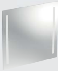
Lichtspiegelement , mit integriertem Lichtschalter, T5, 2 x 24 W, 4000 K, 230 V, ~50 Hz, IP44, Schutzklasse 2, Energieklasse A, 700 x 650 x 36 mm, Modell-Nr. 800470.
