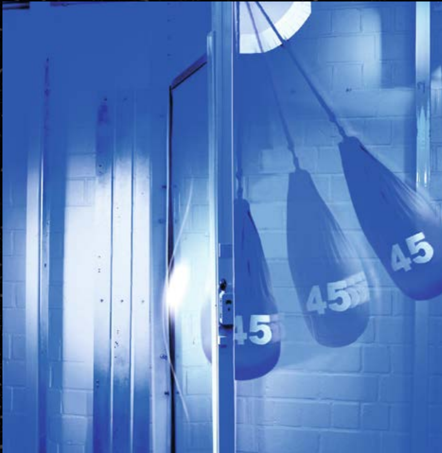
< Im Sandsacktest beweist sich, dass Glas und Kunstglas bei ei- nem eventuellen Sturz nicht aus dem Rahmen fallen.
