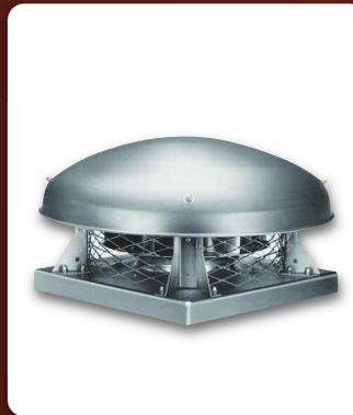
Die horizontal ausblasenden Radial-Dachventilatoren RD EC stehen mit Förderleistungen von 2200 bis 8360 m<sup>3</sup>/h zur Verfügung und sind für Fördermitteltemperaturen bis +40 °C geeignet. In robuster Flachbauweise gefertigt, sind sie weitgehend korrosions- und witterungsbeständig und mit einer großzügig überdeckenden Regenhaube ausgestattet.
