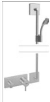
**HANSAMATRIX Fertigmontage-Installationspaket 01 Einhand-Batterie, DN 15 (G 1/2)\***
